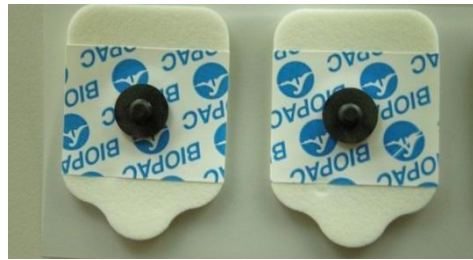
Figura 4.2: Electroodos descartables EL509 Ag-AgCl para la medición del EDA.
