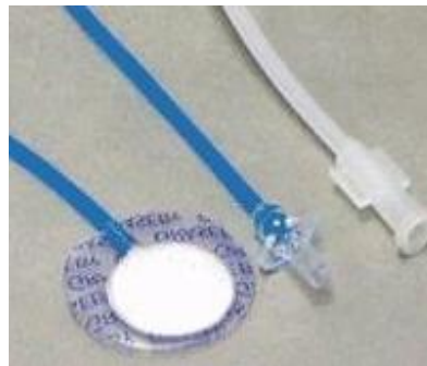
Figura 4.5: Electrodo DA RX100 utilizado para la adquisición de la señal respiratoria.
